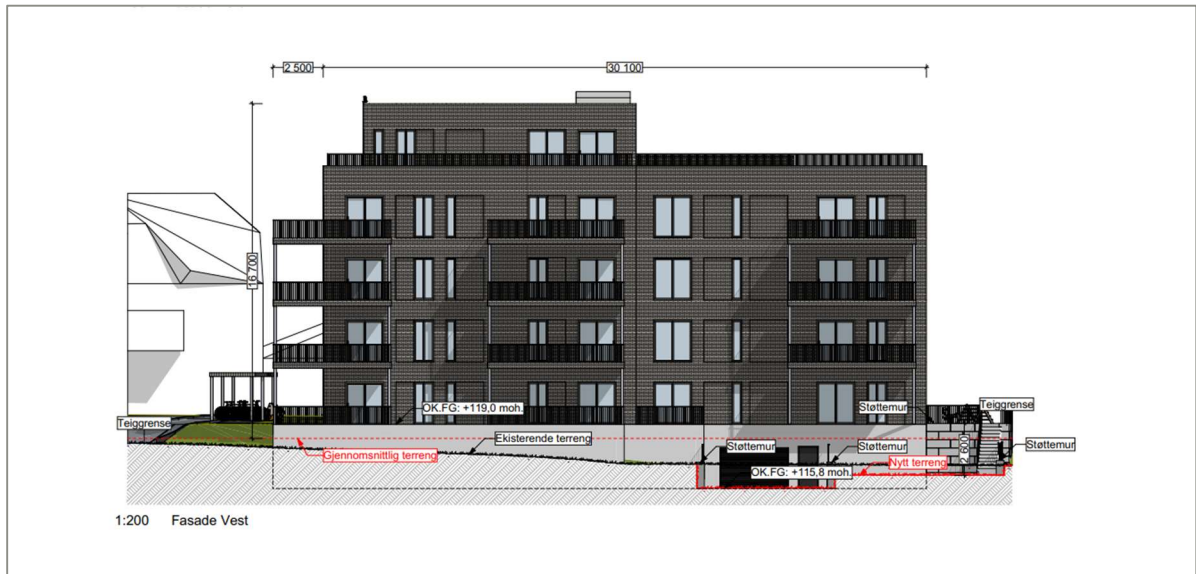
Utsnitt av fasadetegning mot Vest. Rød linje markerer nytt terreng og gjennomsnittlig terreng.
